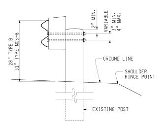
ADJUSTING TYPE B OR TYPE MGS-8
