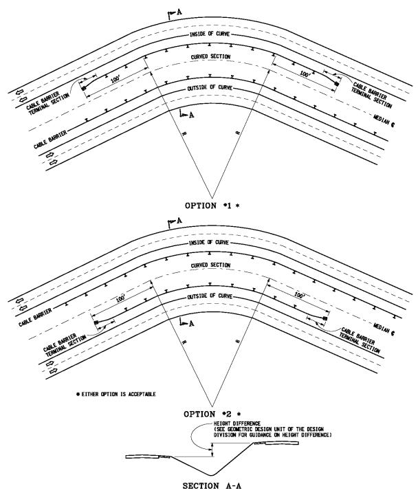
RECOMMENDED CABLE BARRIER PLACEMENT ON CURVED ROADWAYS
