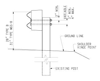
ADJUSTING TYPE B OR TYPE MGS-8 GUARDRAIL HEIGHT ON EXISTING STEEL POSTS
