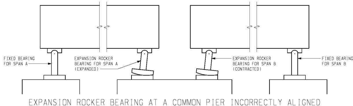
EXPANSION ROCKER BEARING AT A COMMON PIER INCORRECTLY ALIGNED
