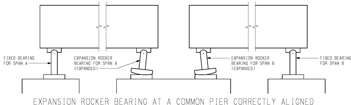
EXPANSION ROCKER BEARING AT A COMMON PIER CORRECTLY ALIGNED
