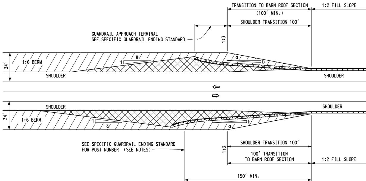
**BEAM GUARDRAIL AT EMBANKMENTS - TWO-WAY ROADWAYS**
