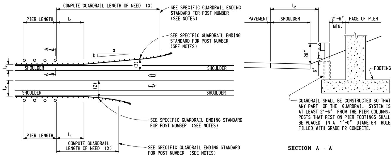
**BEAM GUARDRAIL AT PIERS - LOCAL ROADWAYS - UNDER**
