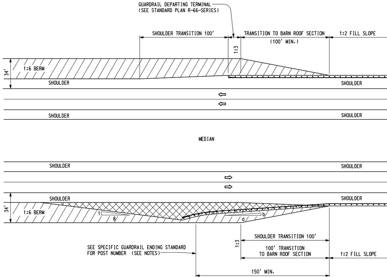
**BEAM GUARDRAIL AT EMBANKMENTS - DUAL ROADWAYS**
