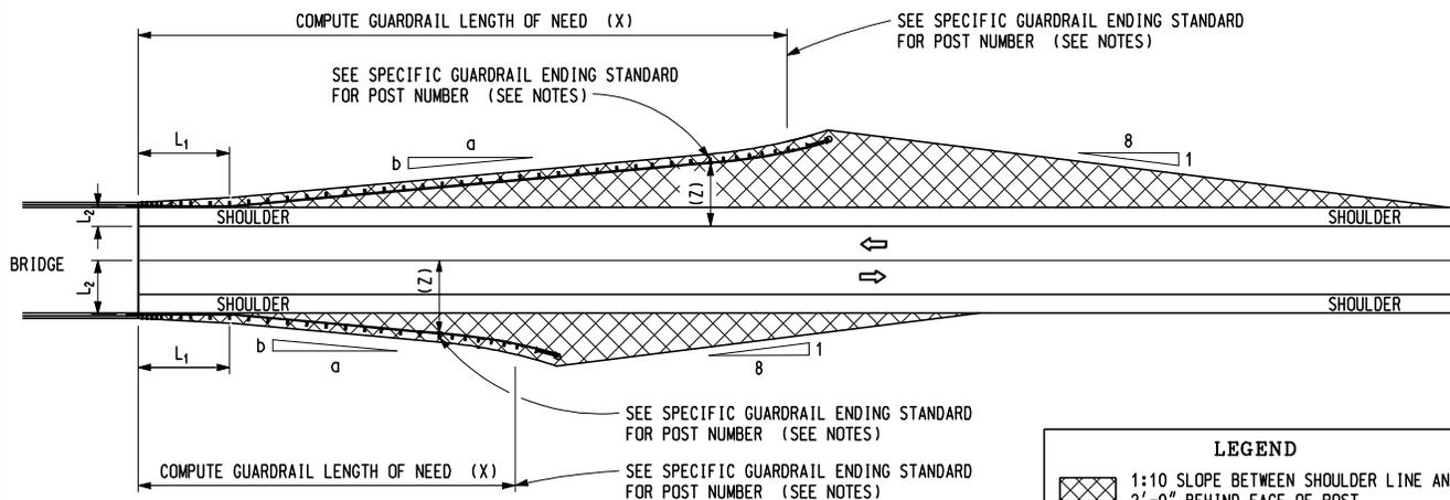
**BEAM GUARDRAIL AT BRIDGES - LOCAL ROADWAYS - OVER**
