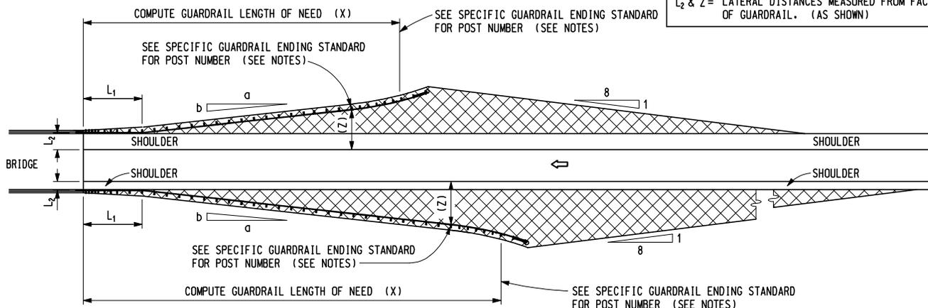
**BEAM GUARDRAIL AT BRIDGES - SINGLE RAMPS**
