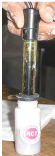
(d) RCT Extraction liquid with electrode
