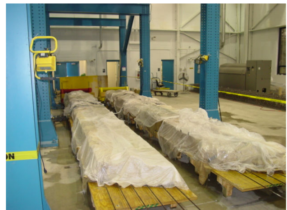
(d) Covered box-beams
