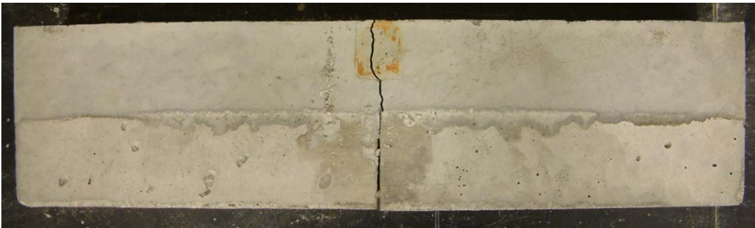
(d) HES-Concrete / Concrete (Rough Interface)
