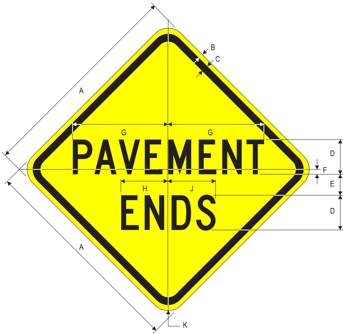
W8-3 PAVEMENT ENDS
