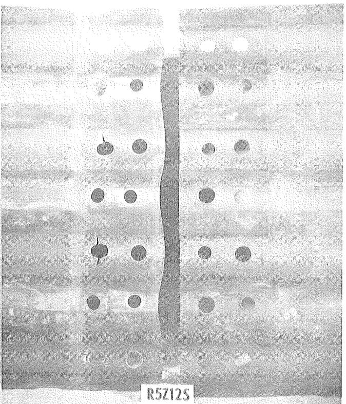
TYPICAL FAILURE - DOUBLE BOLTED JOINTS
