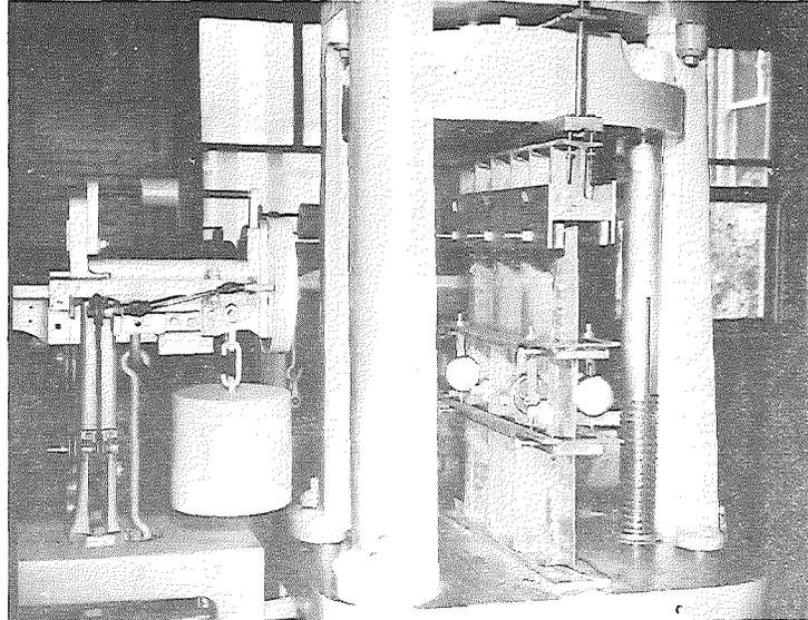
▲ FIGURE 5. TEST FOR JOINT SLIPPAGE IN UNIVERSAL RIEHLE TESTING MACHINE.
