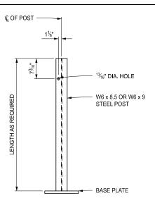
STEEL POST DETAIL FOR GUARDRAIL, TYPE MGS-8
